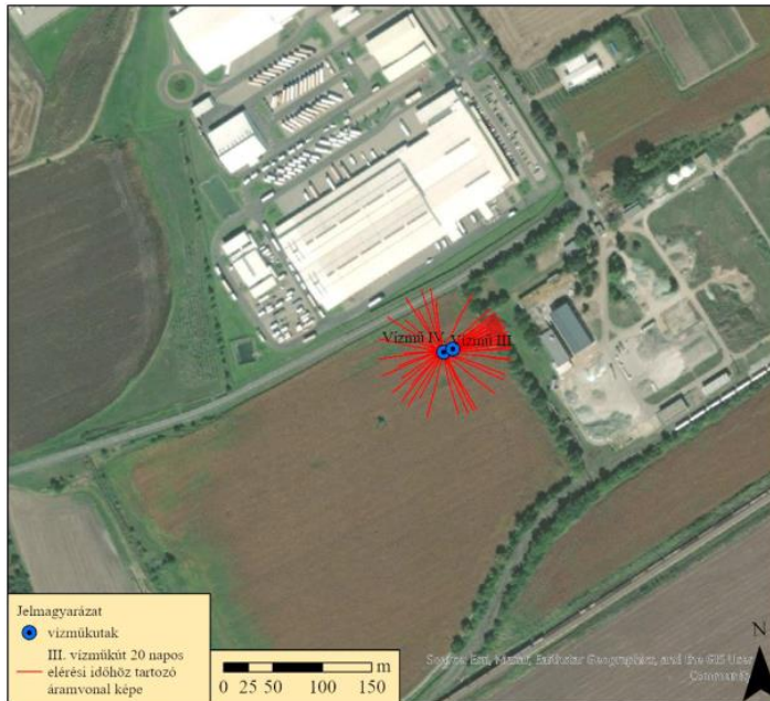
5. ábra A III. sz. vizműkút belső védőidomának felszíni vetülete
