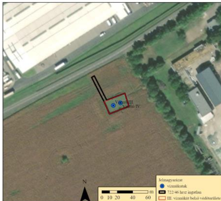
6. ábra A III. sz. vizműkút belső védőterülete
